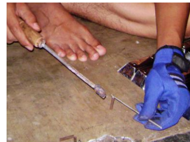
d. Mematri Batang Pendorong
