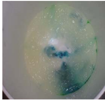
Proses pencampuran bahan sabun organic serbaguna, lidah buaya fermentasi, essence, Pewarna, dan garam.
